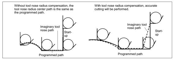
Fig. 6.5.1 (d) Tool path when programming using the imaginary tool nose
