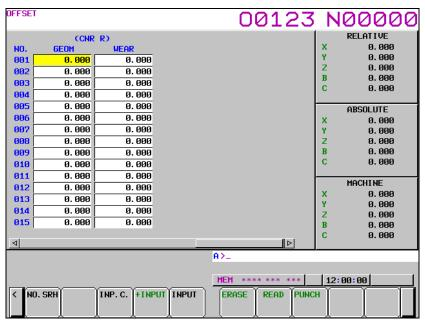
Fig. 1.1.1 (d) Screen used for the cutting point command (10.4-inch display unit)
