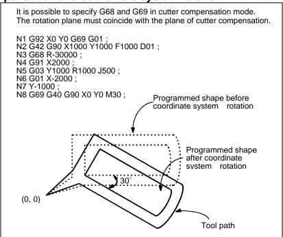
Fig. 6.11 (d) Cutter compensation and coordinate system rotation
