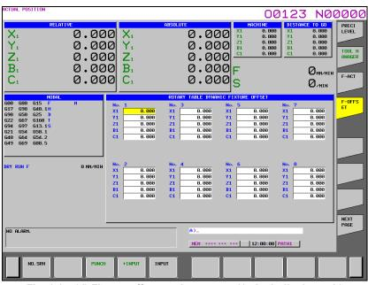
Fig. 1.1.4 (d) Fixture offset setting screen (15-inch display unit)
