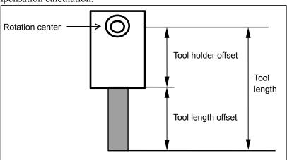
Fig. 6.15 (b)Tool Holder Offset
